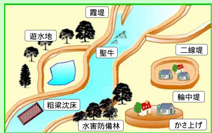
河川の伝統工法
